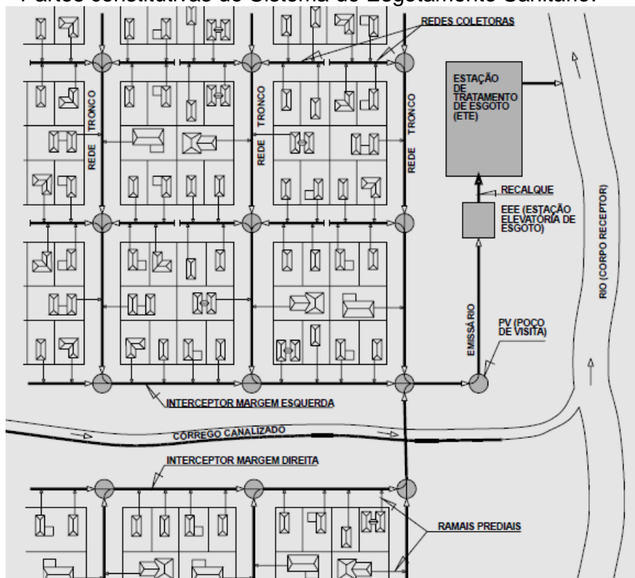
Figura 57– Partes constitutivas do Sistema de Esgotamento Sanitário.
