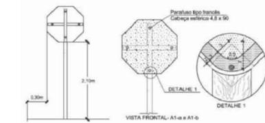
DETALHE FIXAÇÃO DE PLACAS SEM ESCALA
