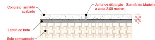
DETALHE PASSEIO PÚBLICO - JUNTA DE DILATAÇÃO SEM ESCALA
