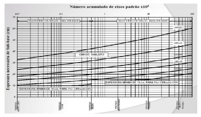
Conforme O CBR de projeto (9,6%) e instruções retiradas do ábaco a espessura de base mínima necessária será de 10 cm, (Para 7%< CBRsub<20%), sendo que o material deverá ter um CBR > 20%.
